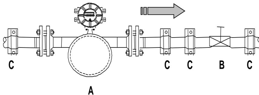
Einbau der Messeinrichtung, A = Sensor, B = Ventil, C = Rohrschellen und stabile Abstützungen
