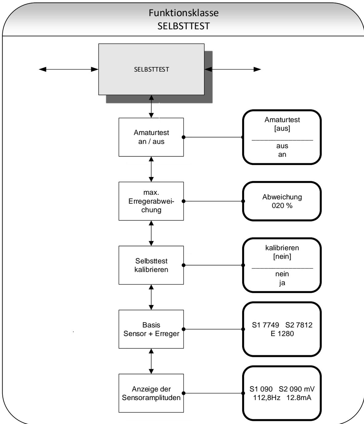
Der Erregerstrom jeder Armatur ist individuell in der Anlage von der Armatur selbst, dem Medium und von den Einbaubedingungen abhängig. Ändert sich der Erregerstrom bei gleichem Medium, so erlaubt dies Rückschlüsse auf möglichen Verschleiß, Änderung der Viskosität, Lufteinschlüsse, etc.
