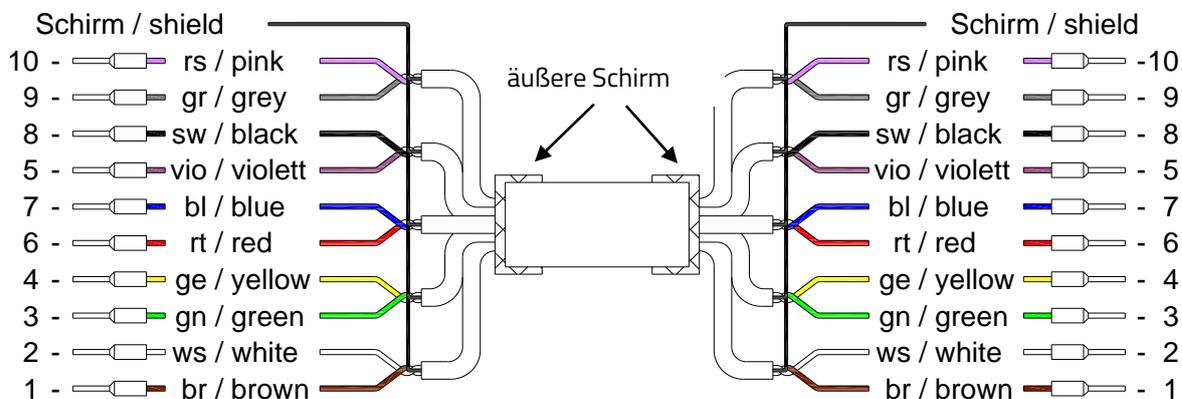
Der äußere Schirm wird mit den Anschlussdose-Kabelverschraubungen auf beide Seiten verbunden. Die Kabel-Paar-Schirme werden mit einander verdrillt in der Anschlussklemme „Schirm / Shield“ in den Anschlussdosen verbunden.
