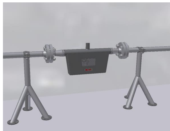
Abb. 2: Abstützung mit Fußstützen
