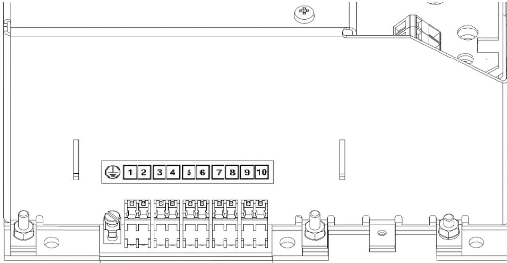
Der Verbindungskabel muss in die unmittelbare Nähe den Anschlussklemmen zugentlastet werden.
