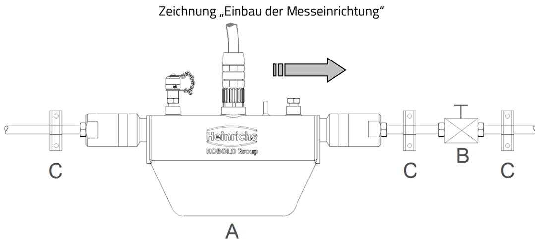
Einbau der Messeinrichtung, A = Sensor, B = Ventil, C = Rohrschellen und stabile Abstützungen
