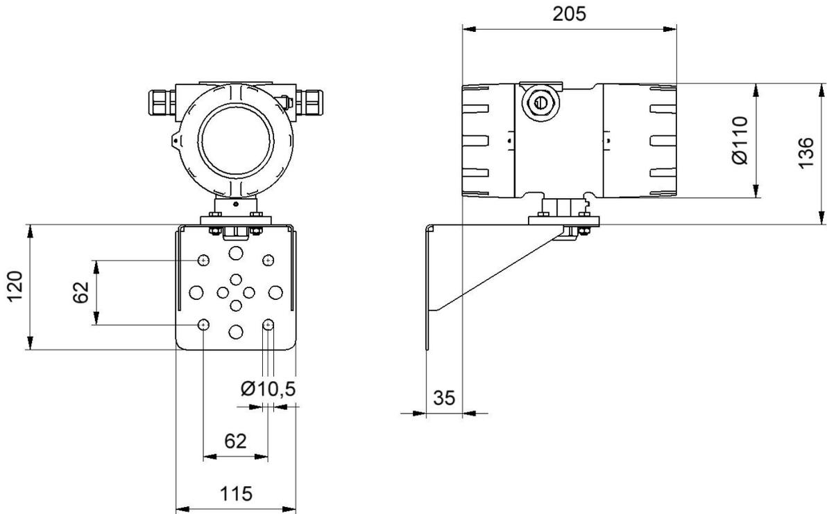
Rohrmontage mit Anschlussdose
