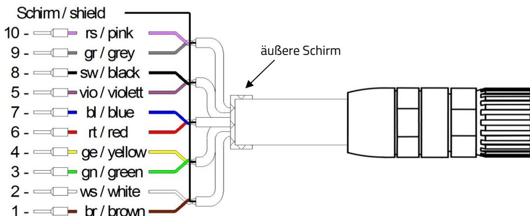
Der äußere Schirm ist mit der Umformer-Anschlussdose Kabelverschraubung auf der eine Seite, und die äußere Hülle des Steckverbinders auf die andere Seite verbunden. Die Kabel-Paar-Schirme werden mit einander und in der Anschlussklemme „Schirm / Shield“ des Umformers verbunden.
