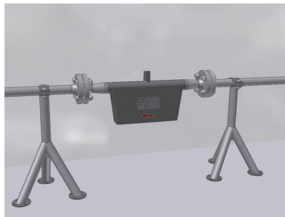
Abb. 2: Abstützung mit Fußstützen
