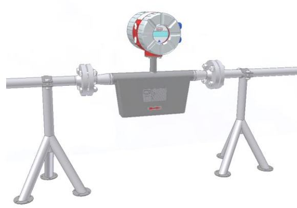
Abb. 2: Abstützung mit Fußstützen
