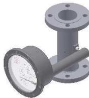
**Ein und Auslaufstecken** vor und hinter dem Gerät sind in der Regel bei linearem Strömungsprofil des Mediums nicht notwendig. Der Einbau von einseitig einschnürenden Armaturen vor dem Gerät ist zu vermeiden. Ist dieses jedoch unerlässlich, sollte minimal eine Einlaufstrecke von  $5 \times D$  und eine Auslaufstrecke von  $3 \times D$  vorgesehen werden.
