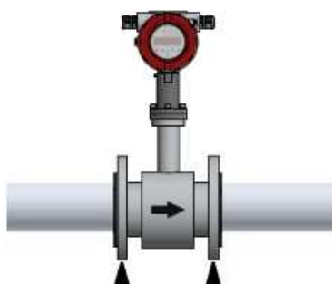
starke Vibrationen durch Abstützung vermeiden
