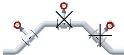
In der Steigleitung einbauen
