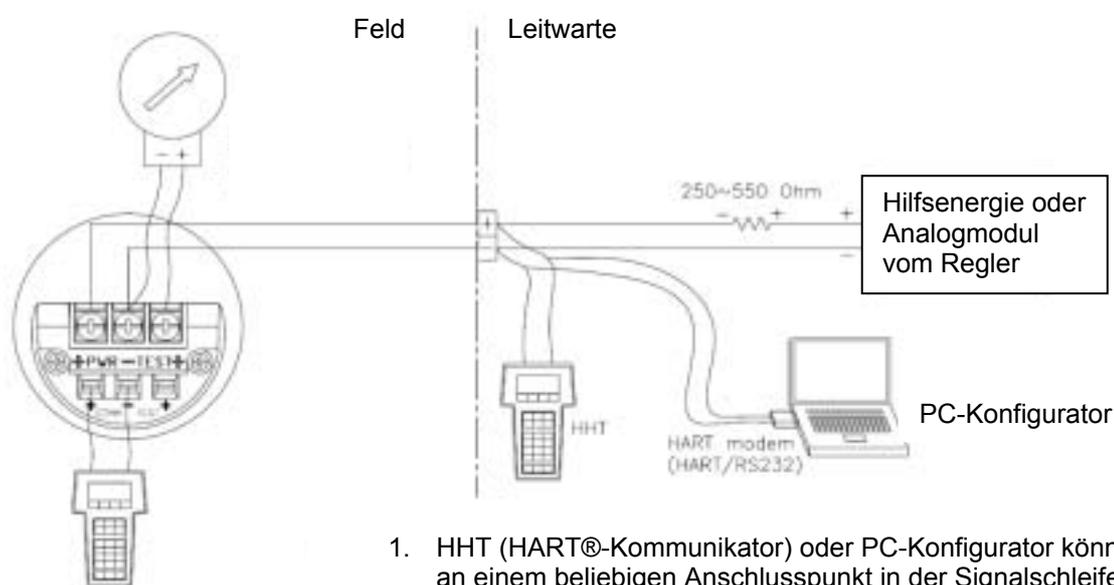
1. HHT (HART®-Kommunikator) oder PC-Konfigurator können an einem beliebigen Anschlusspunkt in der Signalschleife angeschlossen werden.
