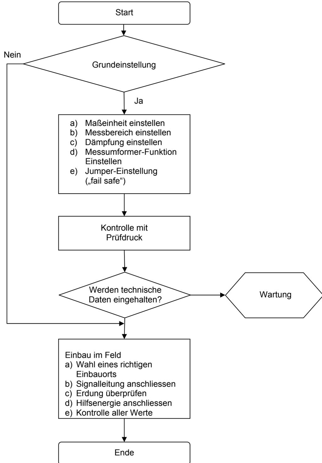
Abbildung 5-1: Inbetriebnahme-Ablaufdiagramm
