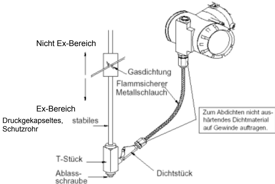
Zum Abdichten des Dichtstücks/Schlauch nach dem Verkabeln ist eine Dichtmasse zu verwenden.
