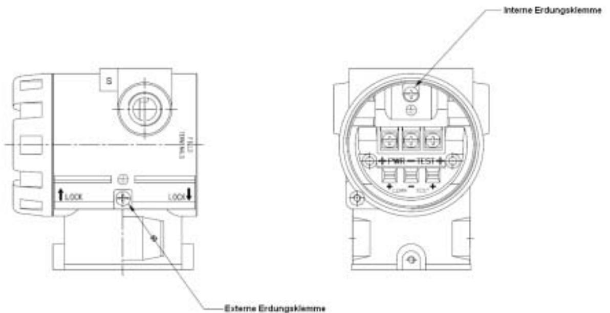
Abbildung 5-5 SMART Druckmessumformer PAD interne und externe Erdungsklemme
