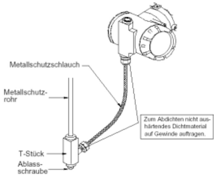
Abbildung 5-4a: Typische Verkabelung anhand eines flexiblen Metallschlauchs
