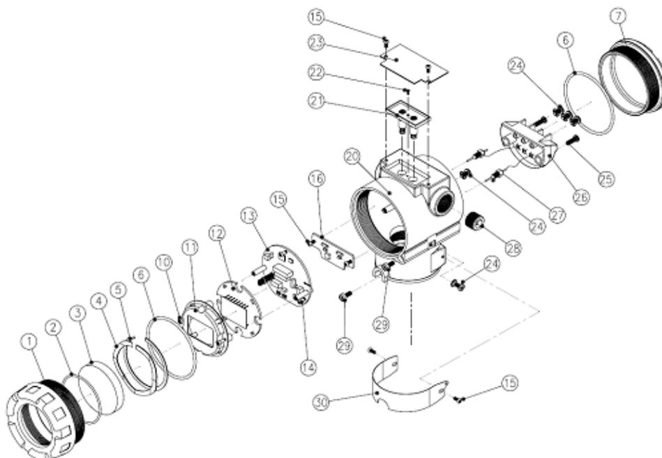
Abbildung 2-1: Darstellung der Einzelteile des Messumformers PAD (Gehäuse)
