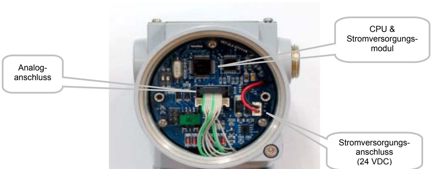
**Abbildung 7.3: Aufbau des Elektronikmoduls im Inneren des Messumformers**
