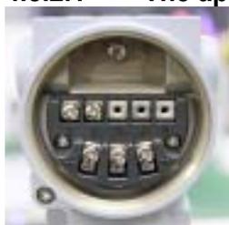
1 : Pulse Output+ , 2 : Pulse Output-
