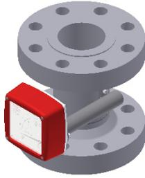
Durch den einzigartigen Aufbau der Messarmatur mit zylindrischem Messrohr und konischem Schwebekörper können die Geräte problemlos mit dickwandigem Messrohr hergestellt werden. Dies ermöglicht den Einsatz in Hochdruckanwendungen, für die es sonst kaum einsetzbare Messgeräte gibt z.B. Sauerogas.
