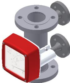
Das zylindrische Messrohr ermöglicht problemlos eine doppelwandige Konstruktion und den Anschluss einer Mediumsbeheizung z.B. für Dampf, Heißwasser oder Thermo-Öl.
