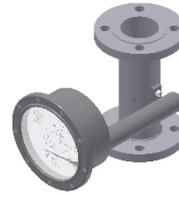
**Ein und Auslaufstecken** vor und hinter dem Gerät sind in der Regel bei linearem Strömungsprofil des Mediums nicht notwendig. Der Einbau von einseitig einschnürenden Armaturen vor dem Gerät ist zu vermeiden. Ist dieses jedoch unerlässlich, sollte minimal eine Einlaufstrecke von  $5xD$  und eine Auslaufstrecke von  $3xD$  vorgesehen werden.
