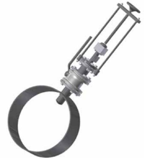
Der Sensor lässt sich in nahezu allen Stellen des Rohrquerschnitts sehr unkompliziert einbauen.
